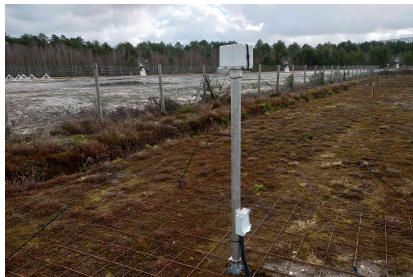
antenne 'LOFAR' modifiée avec un LNA LONAMOS alias LOFARLONAMOS
